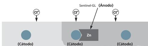
Se colocan los ánodos SENTINEL en la varilla, que puede ser de cualquier medida, dentro de la zona de reparación. El zinc dentro de SENTINEL se convierte en un ánodo de sacrificio, entregando una corriente protectora auto-generada que transforma el concreto adyacente en un cátodo, esto pasiva completamente la corrosión del acero.
